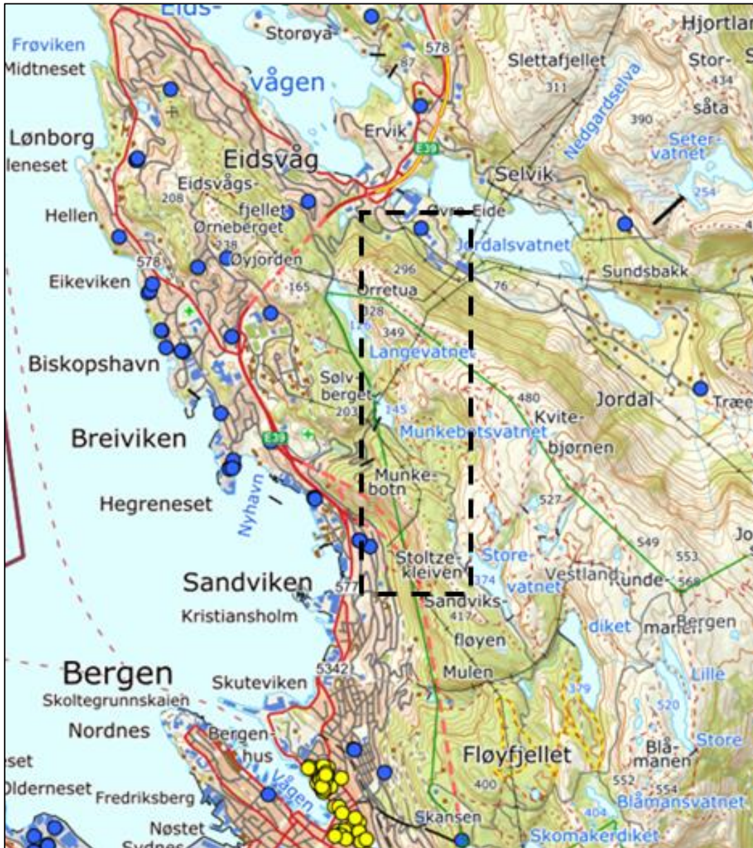
Figur 4-4: Oversikt over brønner. Blå sirkler er fjellbrønner og gule sirkler er løsmassebrønner. Området for planlagt forlengelse av Fløyfjell-tunnelen er vist.
